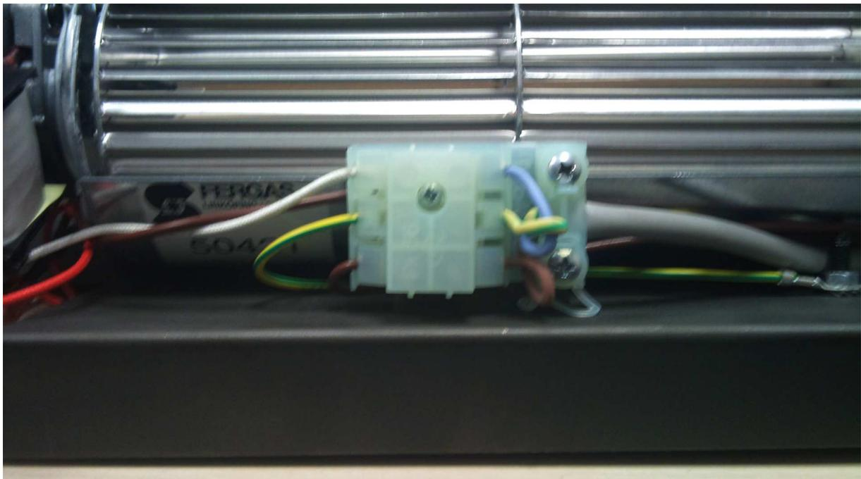
**Le fil vert et jaune (masse) vissé à la carcasse de l'appareil est connecté via le domino au fil vert et jaune provenant du câble d'alimentation. La phase en provenance du câble d'alimentation est quant à elle reliée au fil brun en provenance de la sonde de température bi-métallique (pour fonctionnement en automatique).**
