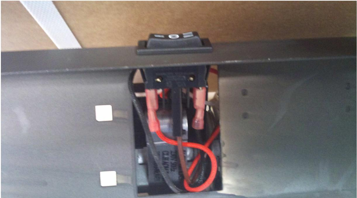
**Le fil brun relié à la position 0 de l'inverseur provient quant à lui de la sonde température bi-métallique (nécessaire pour le fonctionnement en mode automatique).**
