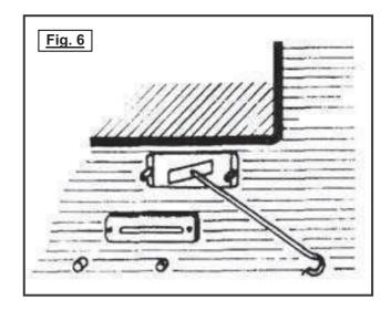
Enlever à l'aide de la raclette les suies accumulées sur le dessus de four en les faisant tomber dans le foyer. Procéder de la même manière sur les parois de passage situées à droite et à l'arrière du four.
